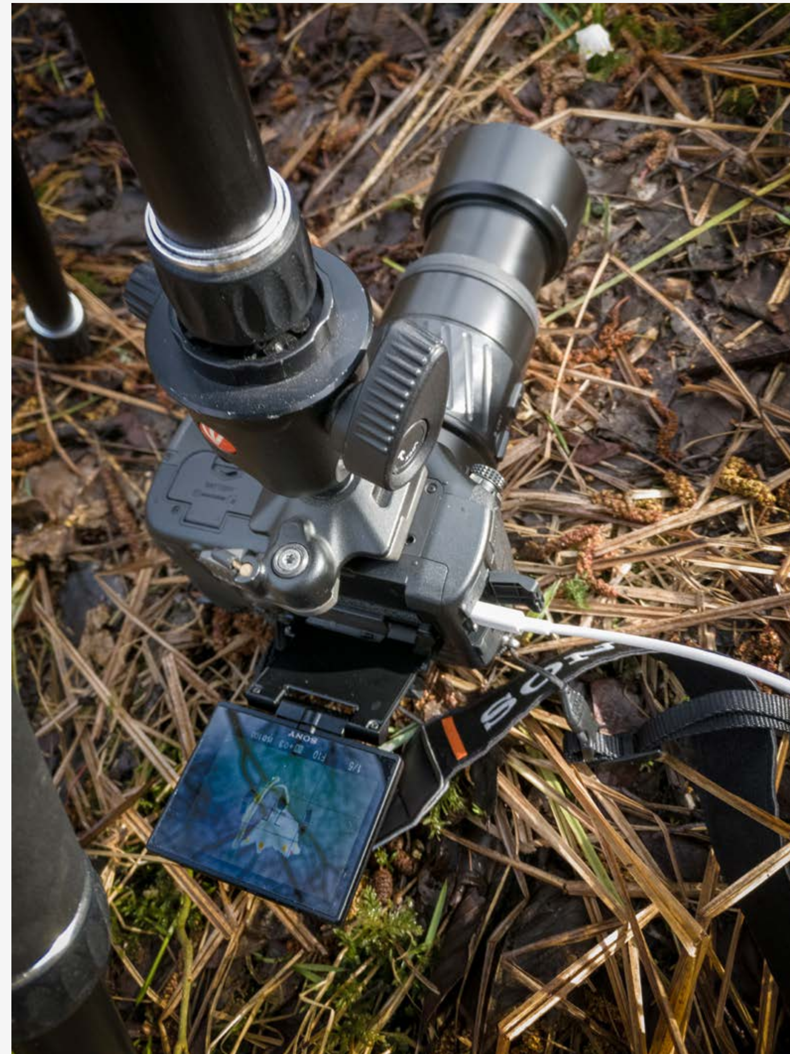
Die Kamera ist in bodennähe; Das USB-Kabel geht von der Kamera zum Surface Go Tablet
